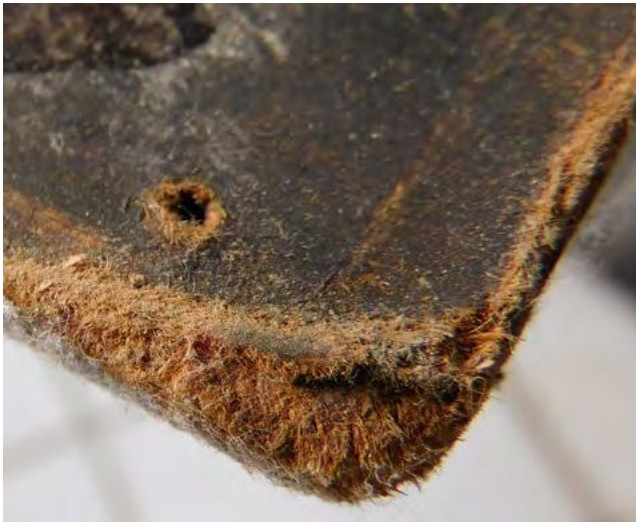
Oben, Abb. 26: „Auffächern“ einer bestoßenen Hartfaser-Ecke, (Noemi Ruiz, 1960er Jahre). FEHLT MUSEUMSHINWEIS
