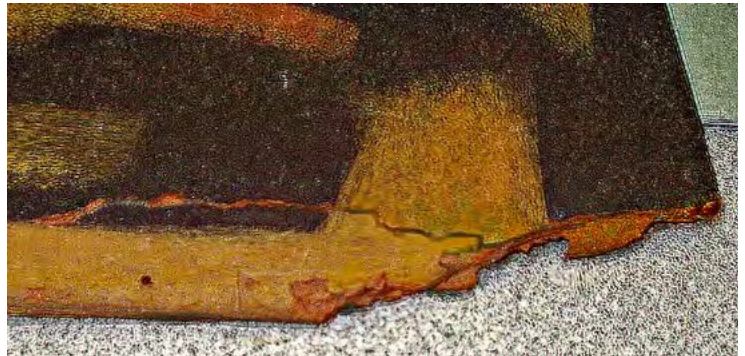
Links, Abb. 25: „Ausfasern“ einer bestoßenen Hartfaser-Ecke, (Noemi Ruiz, 1960er Jahre). FEHLT MUSEUMSHINWEIS
