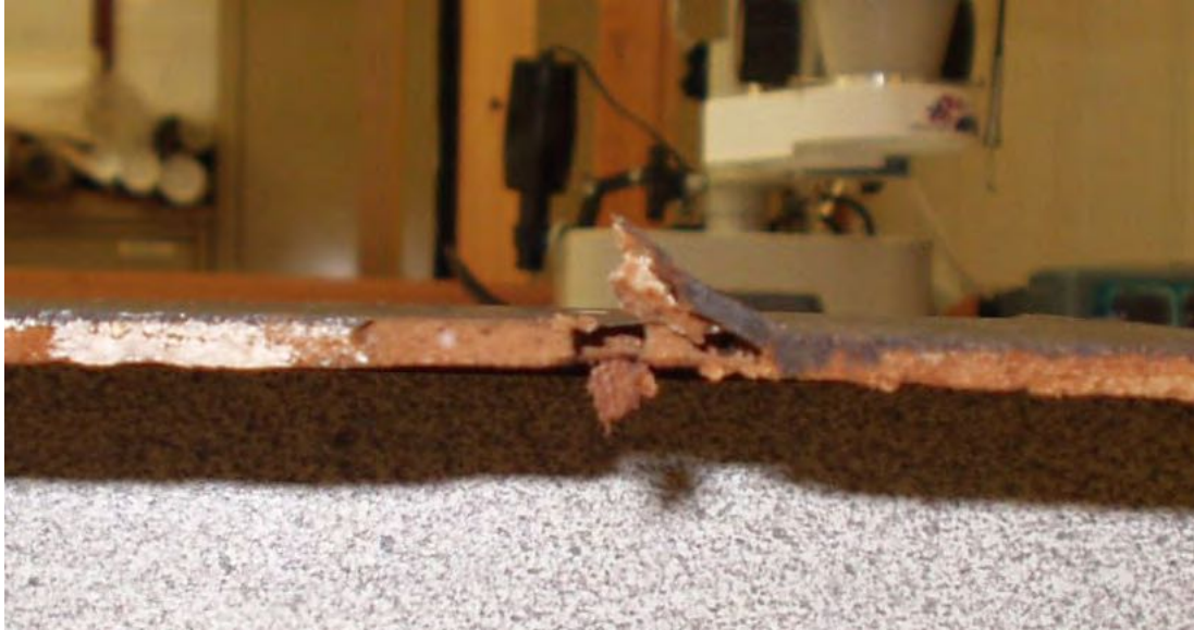
Abb. 22: Fraßgang von Termiten in einer Hartfaserplattenarbeit von Noemí Ruíz der 1960er Jahre FEHLT MUSEUMSHINWEIS
